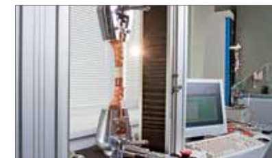
Испытания наконечников на разрывное усилие
