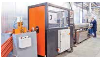
Линии для экструдирования термоусаживаемой трубки
