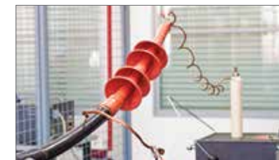
Высоковольтные испытания кабельных муфт
