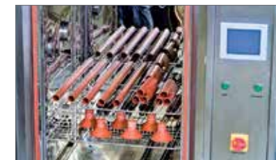
Испытания в климатической камере
